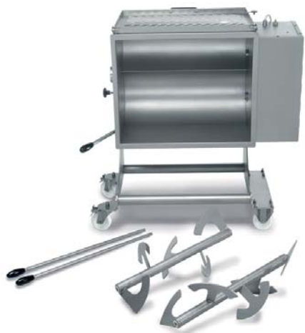
Pale facilmente rimovibili Removable mixing arms
