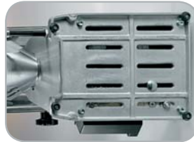
Protezione inferiore Bottom shield
